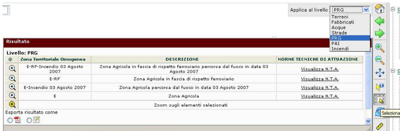
Fig. 04 – Da "Seleziona" definisci il livello in "Applica al Livello" e ottieni l'interrogazione.
